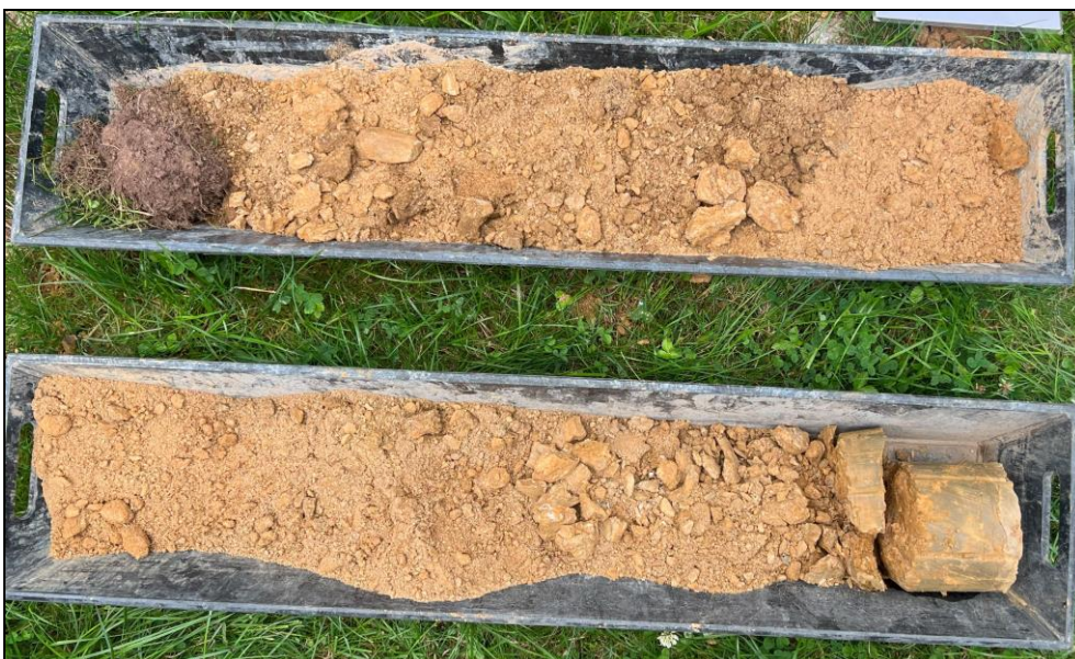
Obr. č. 2 Zastižený geologický profil sondou S-1 v úrovni 0,0 – 2,0 m p. t.
