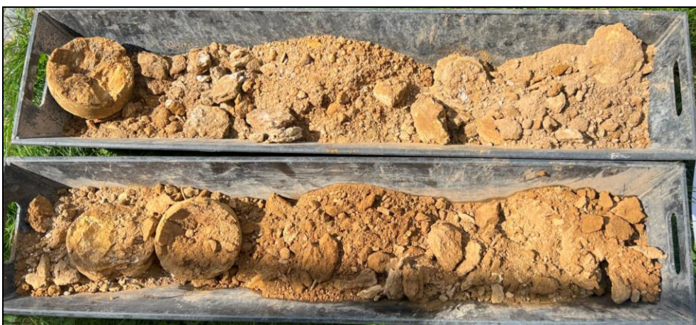
Obr. č. 5 Zastižený geologický profil sondou S-1 v úrovni 6,0 – 8,0 m p. t.
