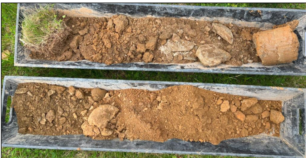
Obr. č. 7 Zastížený geologický profil sondou S-2 v úrovni 0,0 – 2,0 m p. t.
