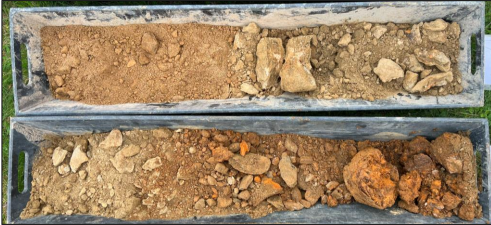
Obr. č. 8 Zastižený geologický profil sondou S-2 v úrovni 2,0 – 4,0 m p. t.
