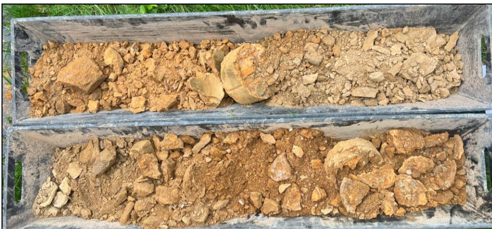
Obr. č. 4 Zastižený geologický profil sondou S-1 v úrovni 4,0 – 6,0 m p. t.
