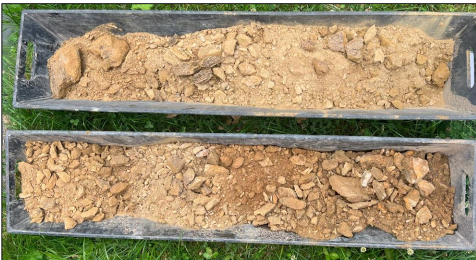
Obr. č. 3 Zastižený geologický profil sondou S-1 v úrovni 2,0 – 4,0 m p. t.
