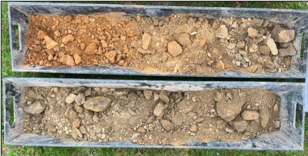
Obr. č. 9 Zastižený geologický profil sondou S-2 v úrovni 4,0 – 6,0 m p. t.
